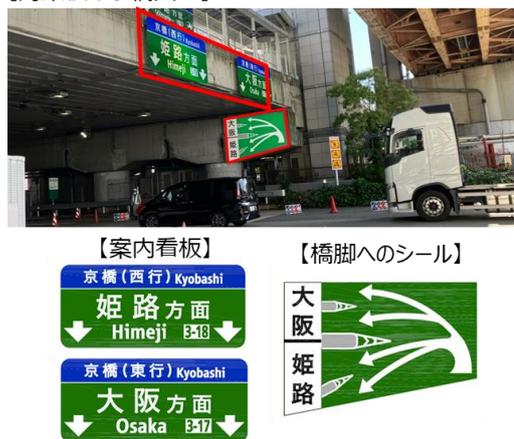
図-3 RN工事で実施した京橋入口での誤進入対策
